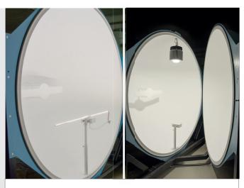
Sia per i test QA obbligatori che per la classificazione della durata nominale, ISOLED® misura tutte le lampade/apparecchiature a LED con chip LED integrato in una delle due sfere integranti (diametro 0,5 m e 1,7 m).
