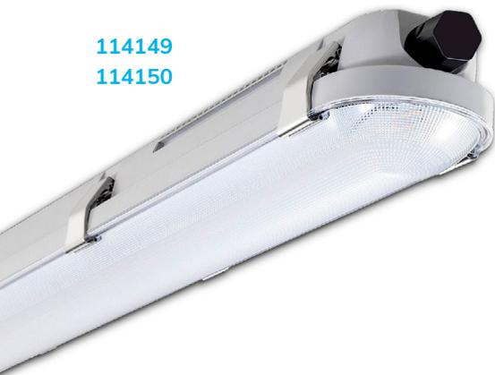
Hochwertige Wannenleuchten mit Edelstahlklammern inkl. Befestigungsmaterial, seitlicher oder rückseitiger Anschlussmöglichkeit und 5-poliger Federsteckklemme mit je zwei Kontakten zur praktikablen, Durch- und Weiterverdrahtung. Die Möglichkeit der Farbtemperaturauswahl und Regelung der Leistungsaufnahme ermöglicht eine individuelle Anpassung an den Kundenwunsch und das Einsatzgebiet.
